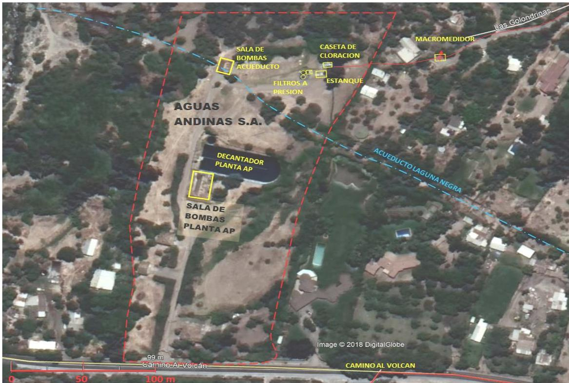
Figura 6: Planta de tratamiento de agua potable Aguas Andinas
