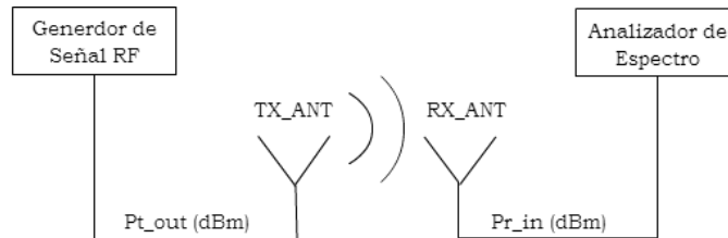
Figura 4.1. Esquema de configuración de enlace simulado.
