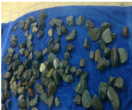
Figura 7.3.1: “Determinación de la pesada del árido saturado superficialmente seco”
