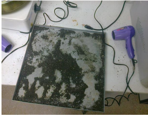
Figura 7.4.1: “Secado de la muestra de arena”
