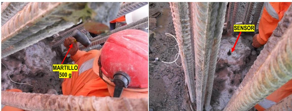
Figura 8.6: Operador realizando ensayo de integridad PIT.
