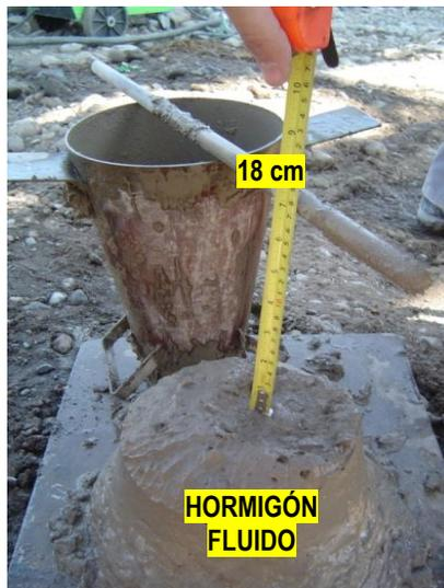
Figura 6.21: Ensayo de cono de abrams 18 cm, hormigón fluido.
