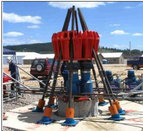
Figura 8.3: Ensayo de carga estática vertical a compresión.
