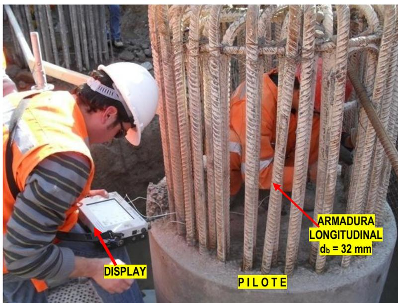
Figura 8.5: Operador realizando ensayo de integridad PIT.
